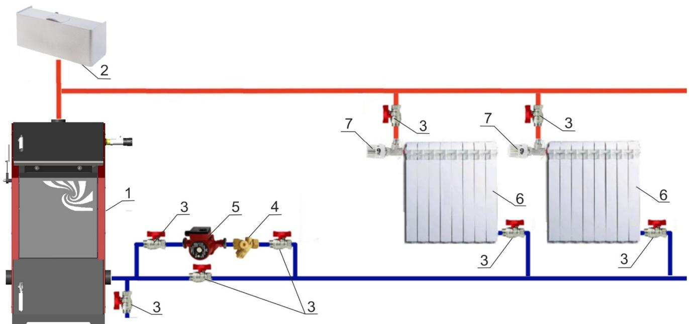
**Рис. 8** Схема подключения котла к открытой системе с принудительной циркуляцией теплоносителя <sup>1</sup>
