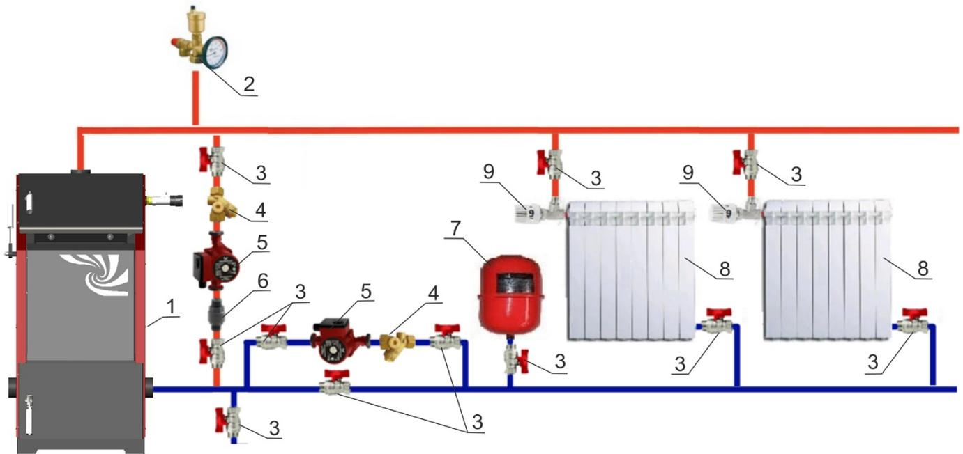
**Рис. 9** Схема подключения котла к закрытой системе с принудительной циркуляцией теплоносителя с рециркуляционным насосом <sup>1</sup>
