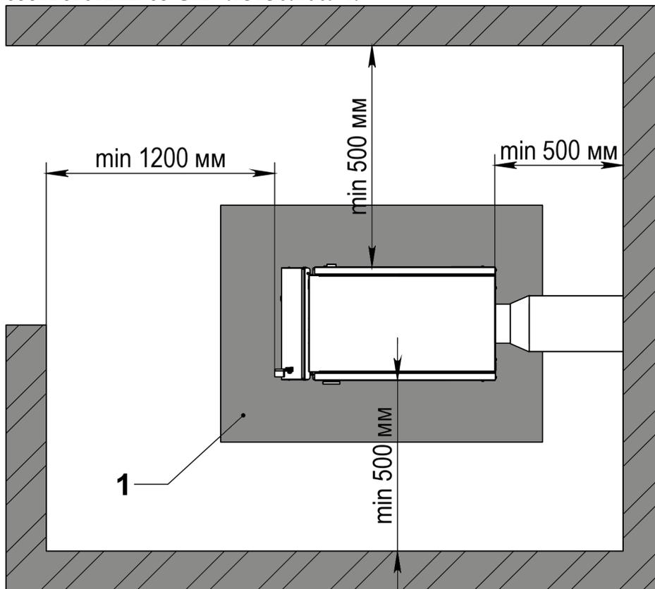
Расстояния безопасности от котла до возгораемых материалов должны быть не менее 500 мм, между верхом котла и потолком 1200 мм, а до противоположной стены 1200 мм.
