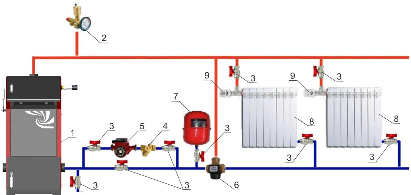
**Рис. 10** Схема подключения котла к закрытой системе с принудительной циркуляцией теплоносителя с термостатическим смесительным клапаном <sup>1</sup>
