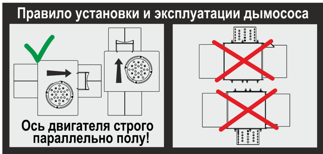
Рис. 9 Установка дымососа
