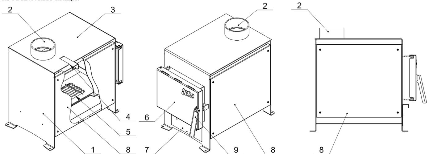
**Рис. 2** Устройство печи **OGNIVO Lite**
