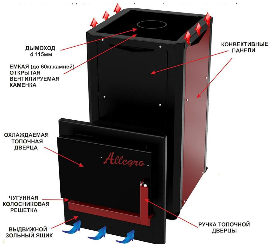
Рис. 2 Устройство печи ALLEGRO
