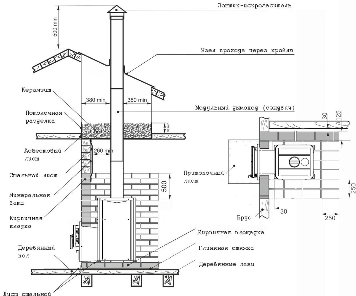
**Рис. 3 Монтаж печи ALLEGRO**
